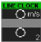
Este icono indica la velocidad actual de la línea de la prueba. En el ejemplo ilustrado, la velocidad es 2 m / s. La barra de línea es de color gris si la velocidad actual se encuentra dentro de los límites de tolerancia que están definidos por los parámetros Speed.Line y Speed.Line.Tol [Line] resp. Speed.Line.Adjust y Speed.Line.Tol.Adjust [la línea]. De lo contrario, la barra de línea es de color negro.
